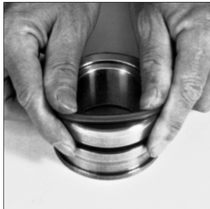
Рис. 4.29 Надевание полиуретанового защитного кольца
