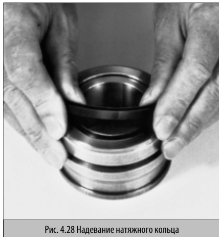
Рис. 4.28 Надевание натяжного кольца
